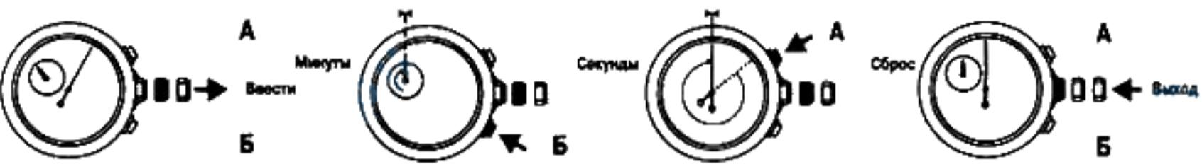
Для выставления секундомера нужно открыть заводную головку до конца. Кнопкой В выставить в нулевое положение минутную стрелку хронографа. Кнопкой А выставить в нулевое положение секундную стрелку хронографа. Убрать заводную головку в исходное положение.
