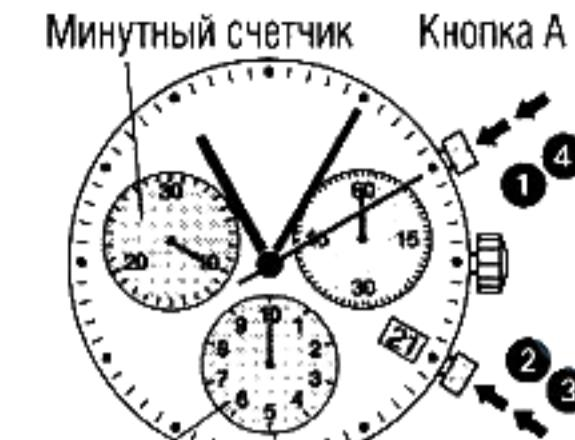
Счетчик 1/10 секунды Кнопка Б
